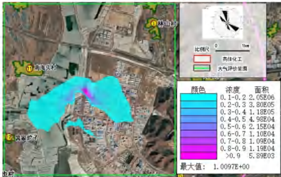
图6-2 本项目正常工况 PM 10 年平均浓度贡献值分布图 (单位: \mu\text{g}/\text{m}^3 )
